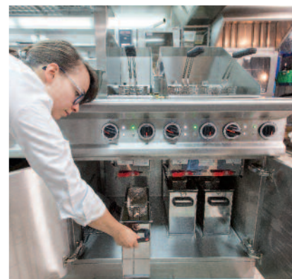
Menu System AG. A gauche, on voit le bain-marie, le multi-cooker à induction et une double salamandre éco. A droite, on voit le fourneau ainsi que la surface ouverte pour le dépôt de casseroles et l'installation de filtrage de l'huile des friteuses dans le bloc inférieur du fourneau.
